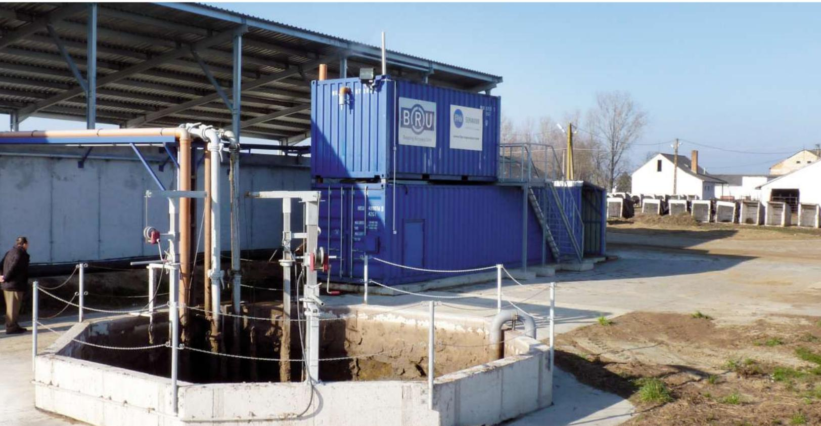
Стоимость высококачественного подстильного материала чрезвычайно выросла в последние годы. Поэтому все большее число передовых молочных ферм переходит на использование биологической подстилки, получаемой из непереваренных волокон (остатков корма), содержащихся в навозе. Разработанная фирмой FAN установка BRU для восстановления из навоза подстильного материала сепарирует, высушивает и дезинфицирует непереваренные волокна. Этот способ позволяет существенно снизить эксплуатационные расходы и
